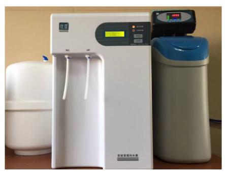
纯水设备采用预处理、混床、反渗透技术□EDI装置以及后级处理等方法,将水中的导电介质几乎完全去除,又
